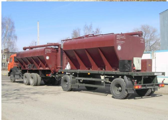
**На платформе прицепа установлен бункер загрузчика сухих кормов ЗСК-15 (4-х секционный).** Привод шнеков автономный, через электродвигатель и редуктор. Питание электродвигателя от сети 380V осуществляется гибким кабелем на месте разгрузки бункера.
