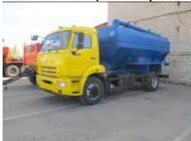
Колёсная формула 4х2; тип ошиновки 2; грузоподъемность шасси – 9,44 т.; мощность двигателя 250 л.с.; модель двигателя Cummins ISB6.7E5 250 (Е-5); система нейтрализации; КПШ ZF6; передаточное отношение главной передачи 6.53; объём топливного бака 350; ТНВД BOSCH; Common Rail; рестайлинговая кабина;
