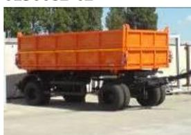
**выгрузка на боковые стороны** грузоподъемность 10 т.; кол-во осей L1 - колес шт/шт - 2/8 с 1 з/к; шины 9.00R20 ; **объем плат-мы 15 м. куб.;** внутренние размеры платформы 5260x2315x1200.; ТСУ на подрамнике, БЗС, V=15 куб. м. Полная Масса 16, Г/п.т. 10.78, кол-во осей 2/8+1, ССУ(max) - 870, Ось - FUWA, Подвеска пневмо.(П)/ рессорн.(Р) – Р, Шины - 9.00R20, внутр. размеры платформы мм.- 5260\*2315\*1200
