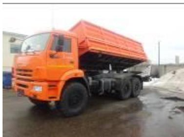
**Шасси КАМАЗ 43118-3027-50 (Евро-5);** колёсная формула бх6; одинарная ошиновка; грузоподъемность шасси 12,72 т; мощность двигателя 300 л.с.; модель двигателя КАМАЗ 740.705-300; КПП 154; передаточное отношение главной передачи 6,53; топливная аппаратура BOSCH; Common Rail; рестайлинг; шины 425/85R21; объём топливного бака 350+210 л; межосевая блокировка; фаркоп типа «крюк-петля». КНОПКА УВЭС
