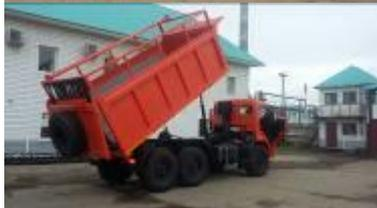
**Шасси КАМАЗ 43118-3027-50 (Евро-5);** колёсная формула бх6; одинарная ошиновка; грузоподъемность шасси 12,72 т; мощность двигателя 300 л.с.; модель двигателя КАМАЗ 740.705-300; КПП 154; передаточное отношение главной передачи 6,53; топливная аппаратура BOSCH; Common Rail; рестайлинг; шины 425/85R21; объём топливного бака 350+210 л; межосевая блокировка; фаркоп типа «крюк-петля». КНОПКА УВЭС
