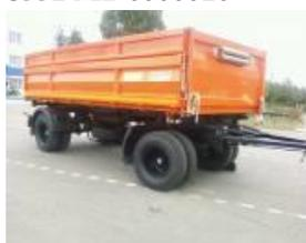
**выгрузка на боковые стороны V=15 куб.м..** Полная Масса 16, Г/п.т. 10,93, кол-во осей 2/8+1, ССУ(max) - 670-970, Ось - FUWA, Подвеска пневмо.(П)/ рессорн.(Р) – Р, Шины - 9.00R20, внутр. размеры платформы мм.- 5476\*2416\*1130.
