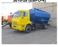
Колёсная формула 4х2; тип ошиновки 2; грузоподъемность шасси – 9,44 т.; мощность двигателя 245 л.с.; модель двигателя Сиmmins ISB6.7e4 245 (Е-4); система нейтрализации; КПП ZF6; передаточное отношение главной передачи 6.53; объём топливного бака 350; ТНВД ВОЅСН; Соттоп Rail; рестайлинговая кабина;
